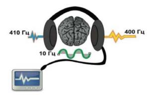
Научно доказано, что частота биений, возникающих при наложении двух звуковых колебаний с близкими частотами, равна разности этих частот. Допустим, одно ухо слышит звук с частотой 400 Гц, а другое -410 Гц, в этом случае оба полушария головного мозга человека начинают работать синхронно, и в результате слушатель ощущает особое звуковое биение с «разностной» частотой, равной 10 Гц.
